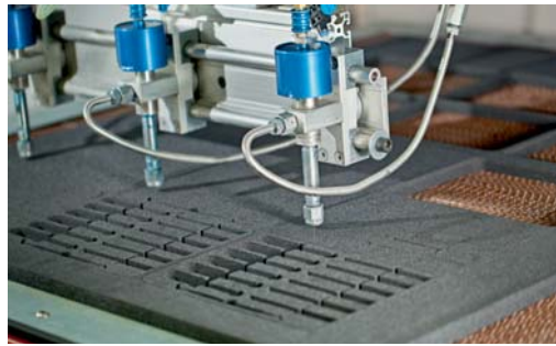
Präziser Zuschnitt mit der Wasserstrahlmaschine Precise cutting by using the water jet cutting machine
